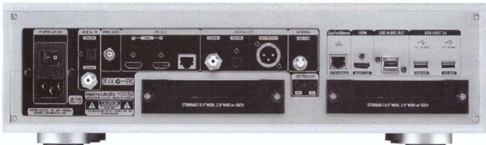
↑リアパネルにはHDD/SSD取り付け用スロットがふたつ用意されている（シリーズの他モデルはひとつ）。各スロット最大6TBのHDD/SSDを取り付けられるので、最大容量は12TBバイトということになる（HDD/SSDは別途購入が必要）。DACとの組合せは、USB接続のほか光、同軸出力や、HDMIなどを使ったPSデジタル出力にも対応している。
